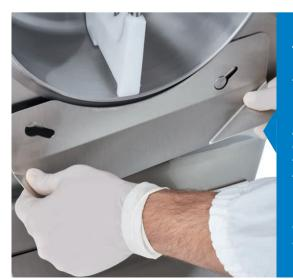
Le cylindre et la tôle frontale forment une pièce unique pour permettre un nettoyage parfait et garantir le maximum d'hygiène.
